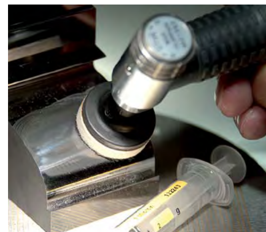
2. Moc polerowania z filcem Ø 30mm
