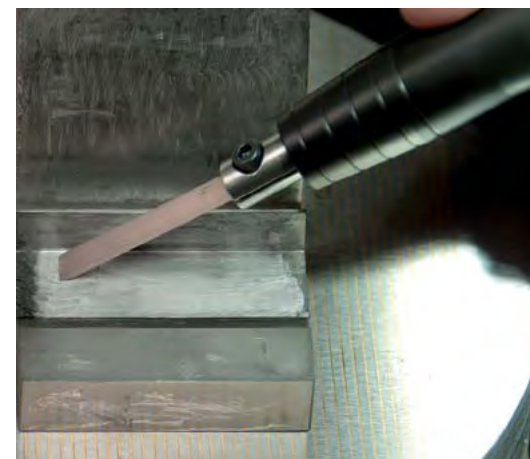
1. Mocny ultradźwięk z pilnikiem ceramicznym
